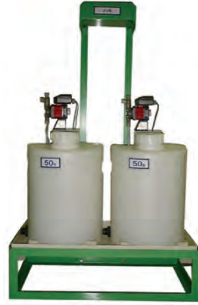
めっき光沢剤補給装置
